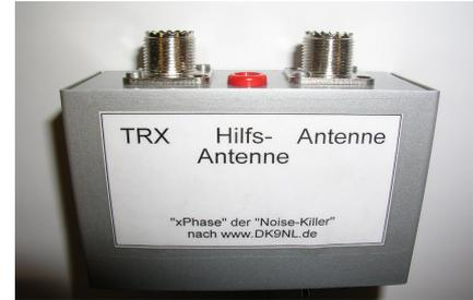
Jetzt geht es darum, dass möglichst das Störgeräusch mit der Stationsantenne und auch mit der Hilfs-Antenne gleichmäßig empfangen wird, um es dann mit dem Poti Phase 1 und Phase 2 gegenseitig auszublenden.
